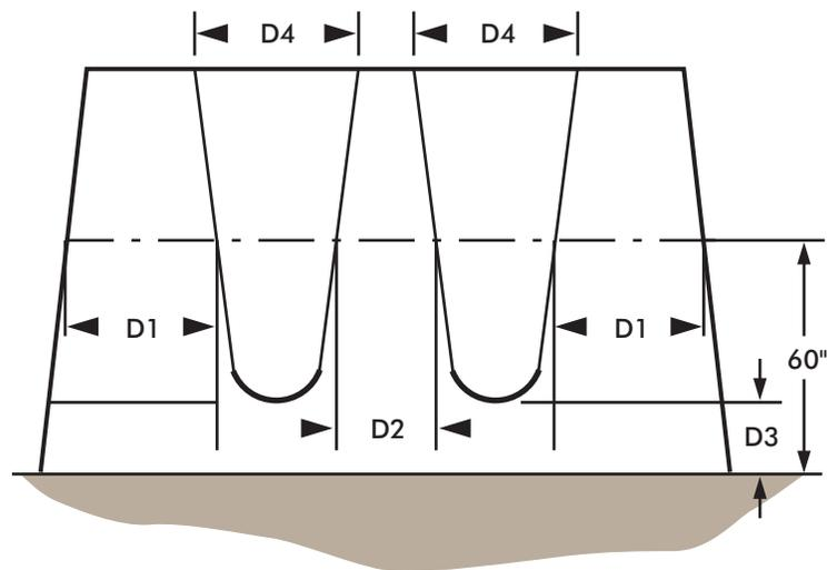
Figura 23. Luces mínimas para columpios de eje sencillo
