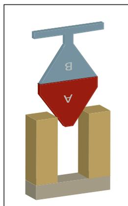
6to: Mientras esté introducida lo más posible, determine si hay contacto simultáneo entre ambos lados angulares de la sección A y los lados de la abertura.
