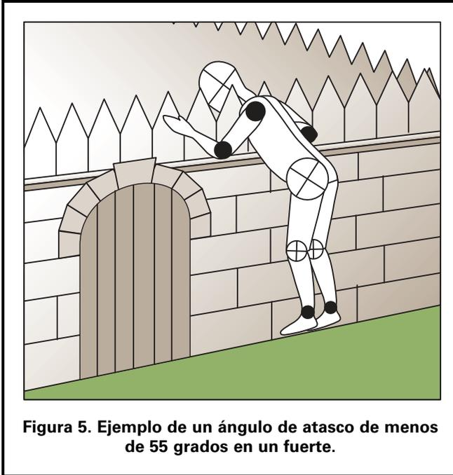
**Figura 5. Ejemplo de un ángulo de atasco de menos de 55 grados en un fuerte.**
