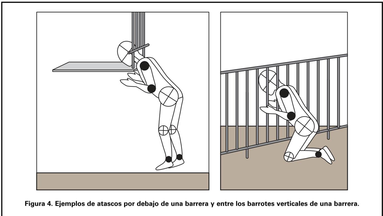
Figura 4. Ejemplos de atascos por debajo de una barrera y entre los barrotes verticales de una barrera.
