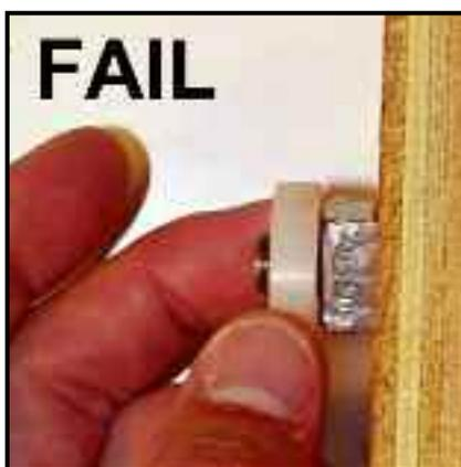
**Figura B11. Determinación de cuándo un saliente es una protuberancia (PASA/FALLA)**
